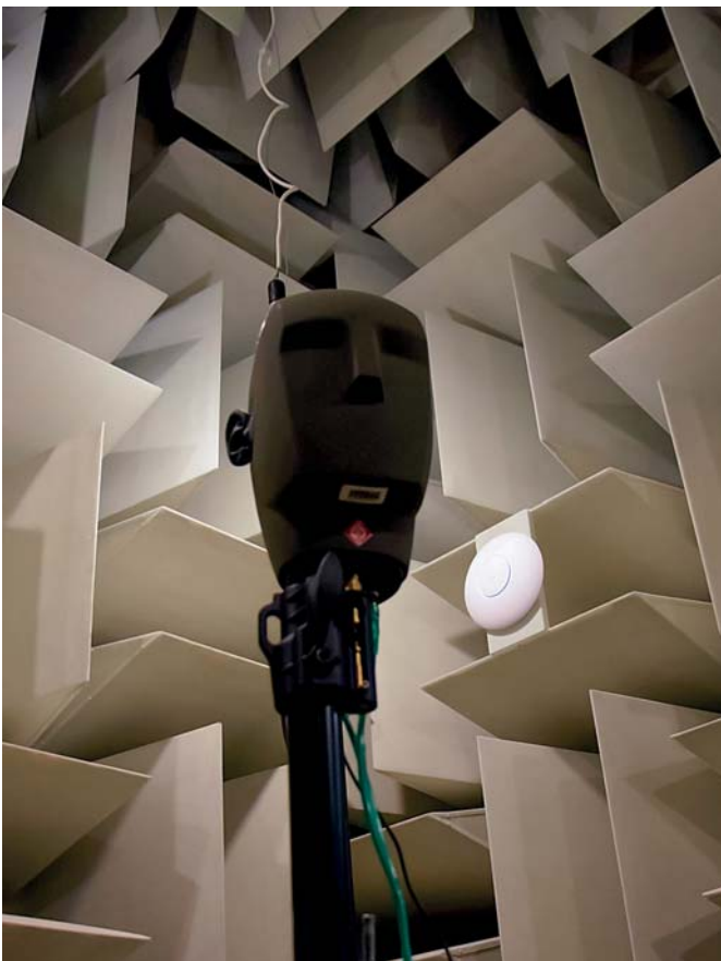
Całkowicie wygłuszone pomieszczenia - laby audio, w których testuje się m.in. rozpoznawanie mowy
