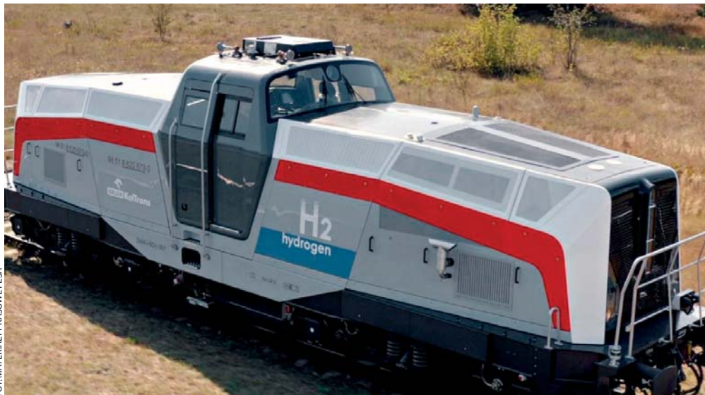
Lokomotywa manewrowa z napędem wodorowym jest pierwszym etapem realizowanego w PESA programu wdrożenia technologii wodorowych w napędach pojazdów szynowych
